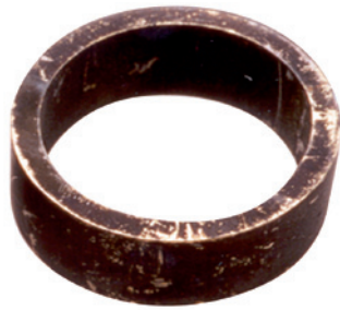
Endommagé par l'attaque chimique due à l'incompatibilité des différentes formulations d'additifs qui se retrouve dans le mélange des fluides hydrauliques
